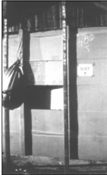
Figura 01 - Ruptura do painel. Sistema construtivo **K**.
