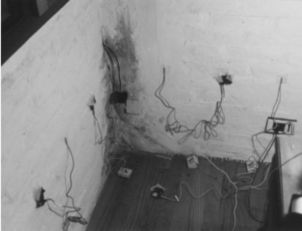
Fig. 2: Foto que muestra la ubicación de los sensores en puntos seleccionados de la grilla de medición.
