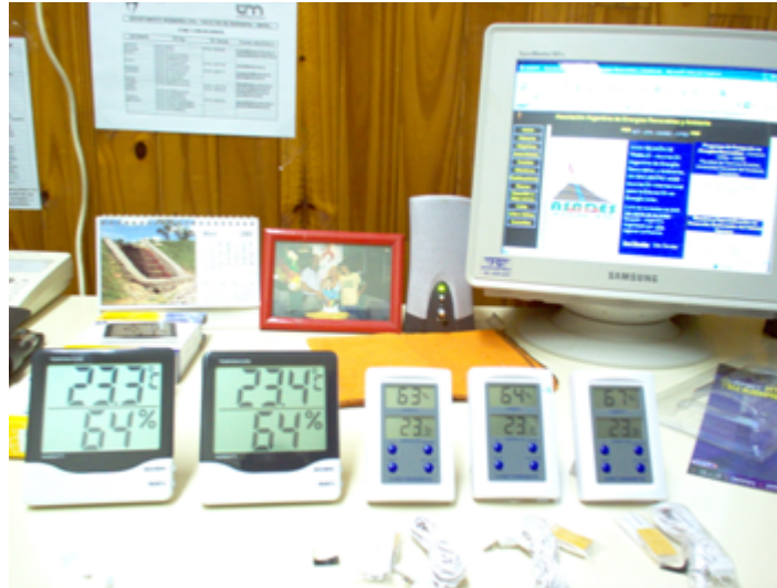
Figura 2: Instrumentos utilizados en la campaña de invierno. Termohigrómetros de máx. y mín.
