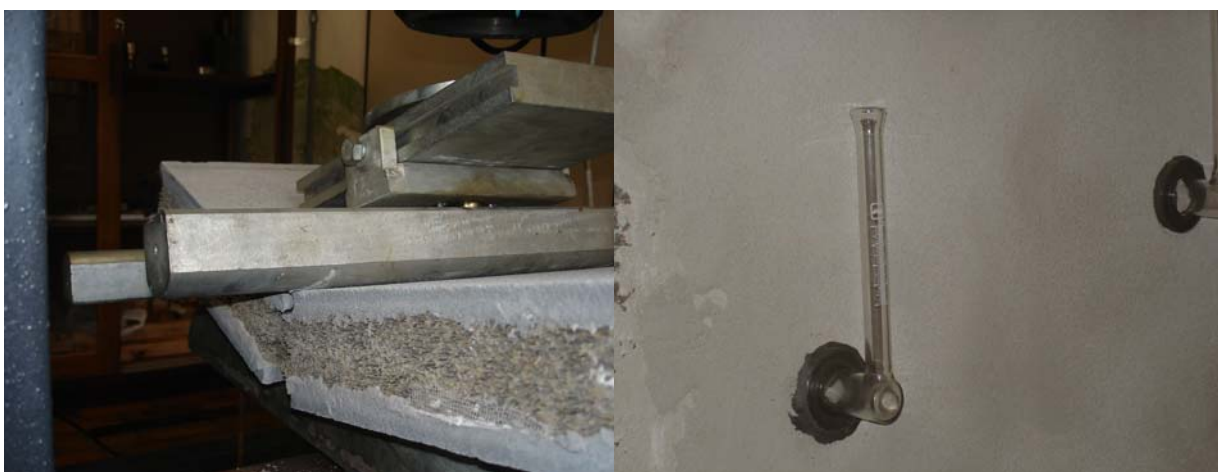
Figura 3 – Ensaio de flexão (esq.); ensaio de estanqueidade (dir.).
