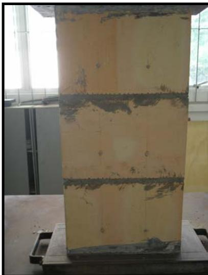
**Figura 2 – Prisma sendo ensaiado à compressão**
