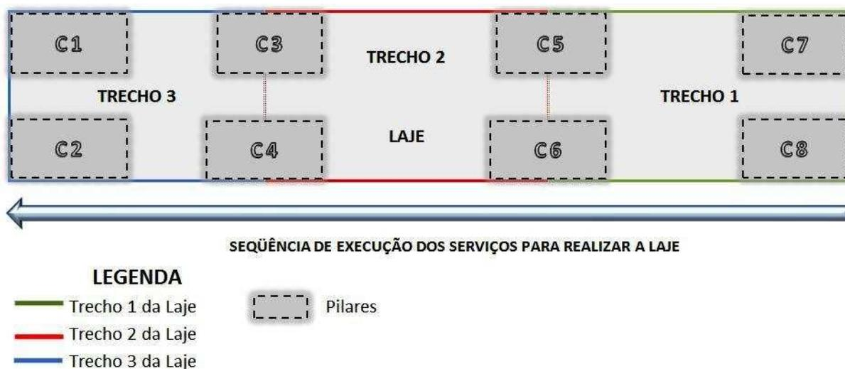
**Figura 2 – Ilustração da Planta Baixa da Estrutura da Turbina**
