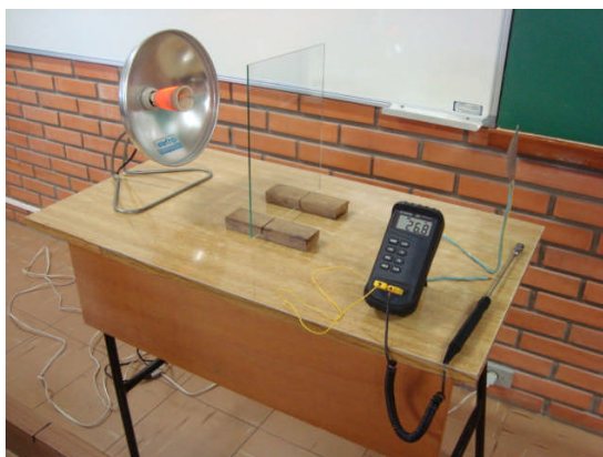
Figura 1. Experimento montado na etapa 1 – ondas longas (estufa).
