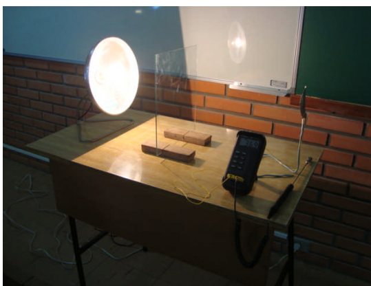
Figura 2. Experimento montado na etapa 2 – ondas curtas (lâmpada).
